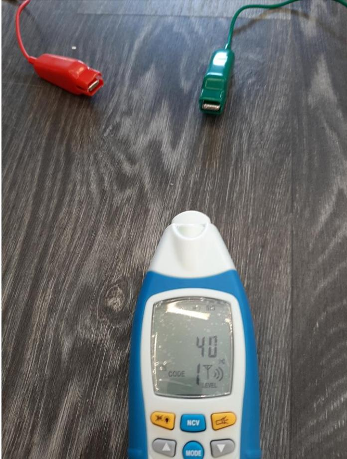
(Bild: Beispiel, wie es nicht gemacht werden sollte. Die grüne Leitung stellt das andere Ende der zur Untersuchenden Leitung dar. Nun wird auf beiden Enden ein Signal eingespeist und der Leitungsbruch kann kaum noch gefunden werden.)
